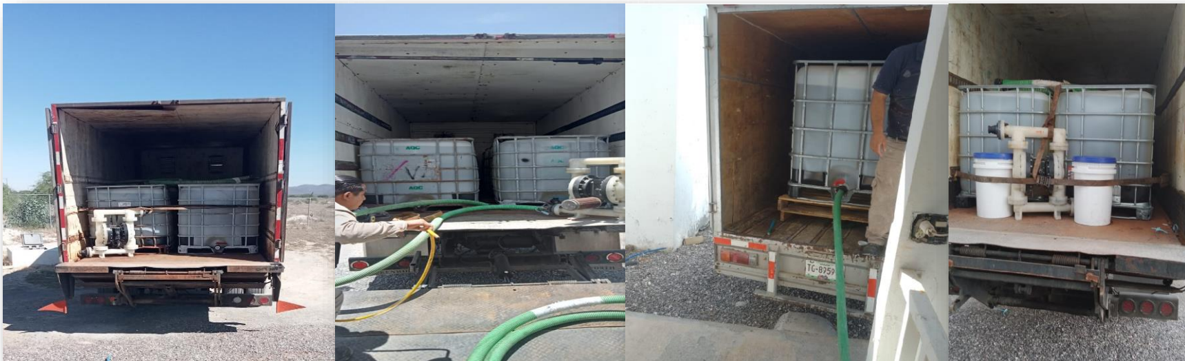
Reposición de manguera por fuga y mantenimiento a bomba
