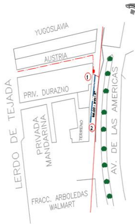
Ampliación de 60 ml de la red de agua potable en Av. Las Américas, tubería PVC HCO de 2".
