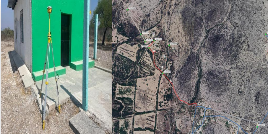
Levantamiento topográfico para generar vértice geodésico para la comunidad de Rancho Alegre
