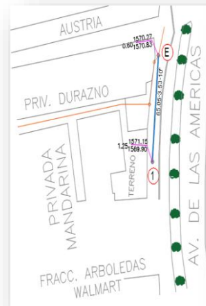
Ampliación de 65 ml de la red de drenaje sanitario en Av. Las Américas, tubería PVC sanitario de 10", un pozo de visita y una descarga
